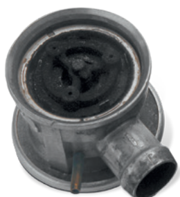
Uszkodzenie spowodowane przez skroplone spaliny
